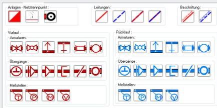
Über eine gut strukturierte Toolbar lassen sich die einzelnen Erzeugungsroutinen für alle Objektarten aufrufen. Plausible Dialoge stehen für die Eingabe von Sachdaten zur Verfügung. Sie lassen sich vom Anwender beliebig erweitern. Für Konstruktions- und Vermaßungszwecke steht die bewährte Grundfunktionalität von Moskito GIS im vollen Umfang zur Verfügung.
